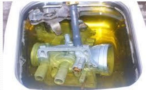
Les échantillons doivent être placés dans un panier grillagé, adapté à la cuve ou, s'ils doivent être traités avec des solutions particulières, dans un récipient en matériau rigide, lui même isolé du fond de la cuve. La plupart des récipients plastiques, relativement souples, absorbent les ultrasons et diminuent grandement le rendement.
