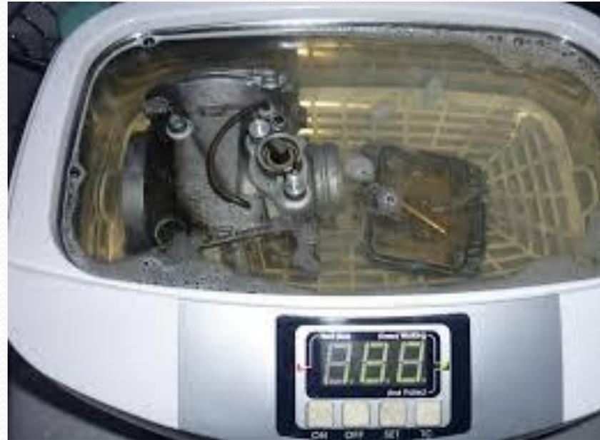
**30 KHz** : Conseillé pour les pièces de verre non volumétrique, métaux et plastiques, dégazage de solvants et solutions aqueuses. Convient très bien au nettoyage de contenants utilisés pour des calcinations, travaux de chimie organique, ...
