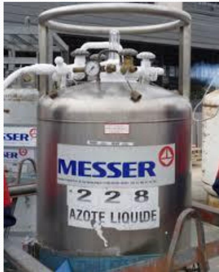
Afin d'éviter les accidents lors de la manipulation des récipients cryogéniques, il faut prendre en compte les propriétés spécifiques de l'azote liquide ainsi que la substitution de l'oxygène de l'air par l'azote en évaporation (risque d'asphyxie) et mettre en place les mesures de sécurité correspondantes. Par exemple des détecteurs sonorisant du taux d'oxygène.
