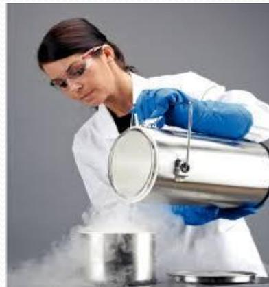
**E-** L'eau (l'humidité) ne doit pas pénétrer dans le récipient cryogénique, de façon à ce qu'il ne se produise aucune obturation de conduite par la formation d'un bouchon de glace.
