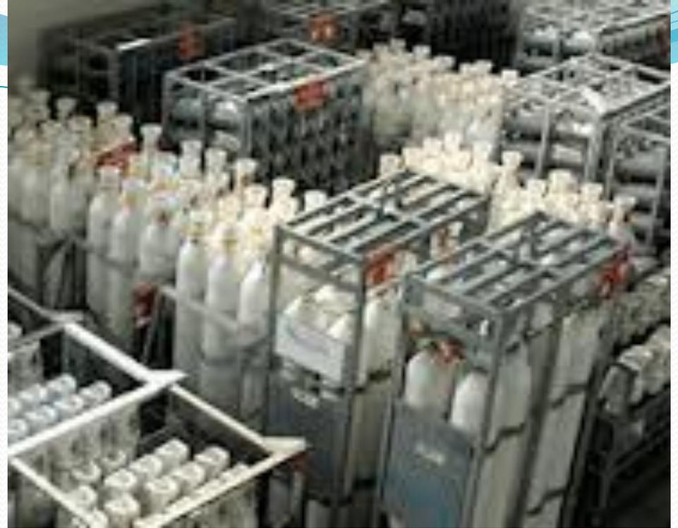
Peu importe l'endroit où les bouteilles sont utilisées, manipulées ou entreposées, il faut toujours les enchaîner ou les attacher de manière sécuritaire à un mur, à un support ou à toute autre structure solide, en position verticale.
