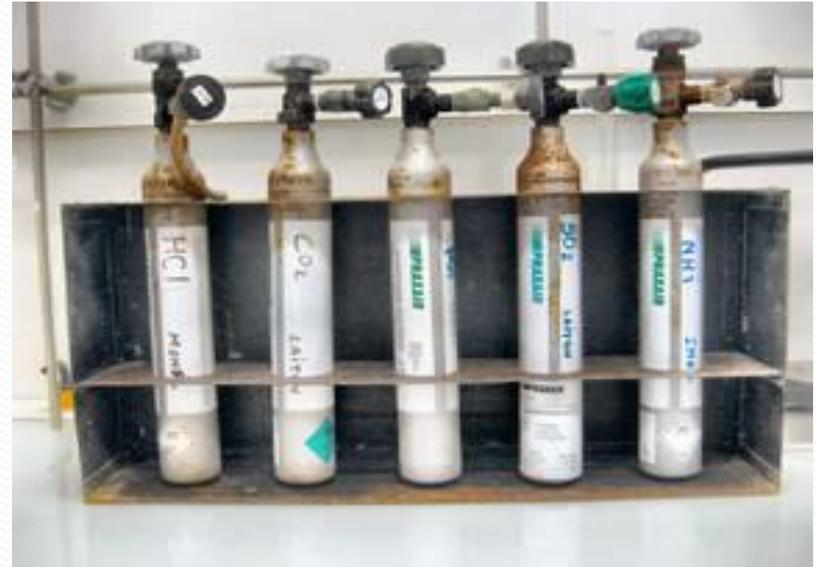
Cylindres de gaz sur un présentoir. Sur chaque cylindre on a indiqué le type de vanne à utiliser.
