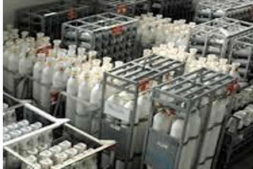
Entreposer les bouteilles de gaz comprimés loin des aires de traitement et de manutention et loin des matières incompatibles.
