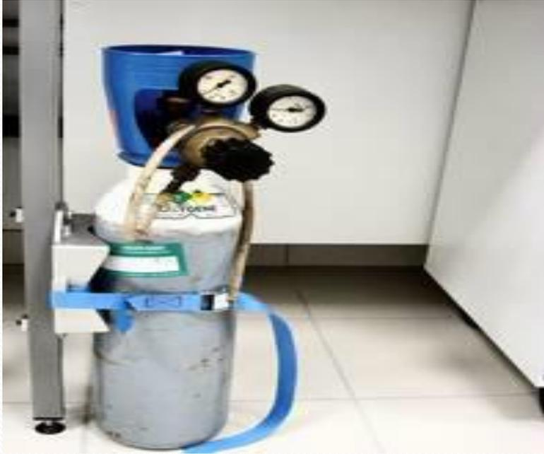
Cylindre de dioxygène fixé au pied d'une paillasse par une bride à sangle
